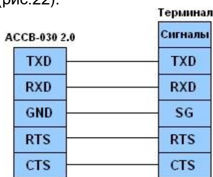
Рис.22. Схема подключения АССВ-030 2.0 к терминалу аппаратного управления потоком.
