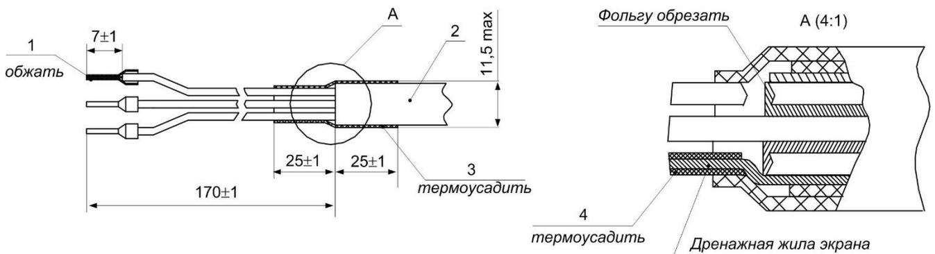
1 – наконечник Order N DN00708 DINKLE; 2 – кабель КВВЭнг  $1 \times 2 \times 0,75 \text{ мм}^2$ ; 3 – трубка термоусаживаемая ТСТ  $\varnothing 11$ ; 4 – трубка термоусаживаемая ТСТ  $\varnothing 2,5$ .
