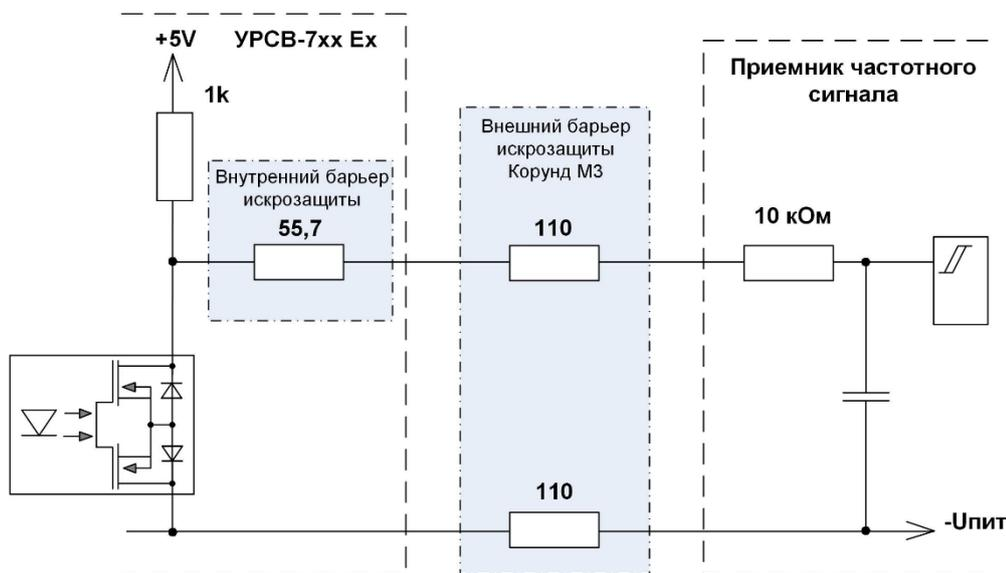
Рис.В.4 - Эквивалентная схема работы на высокоомную нагрузку
