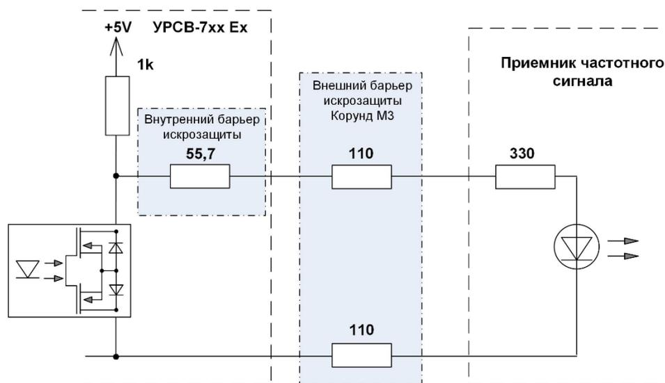
Рис.В.3 - Эквивалентная схема работы на низкоомную нагрузку
