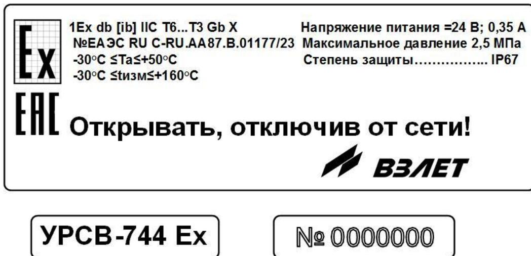
Рис.А.5 - Вид шильдика на верхней части корпуса ВП
