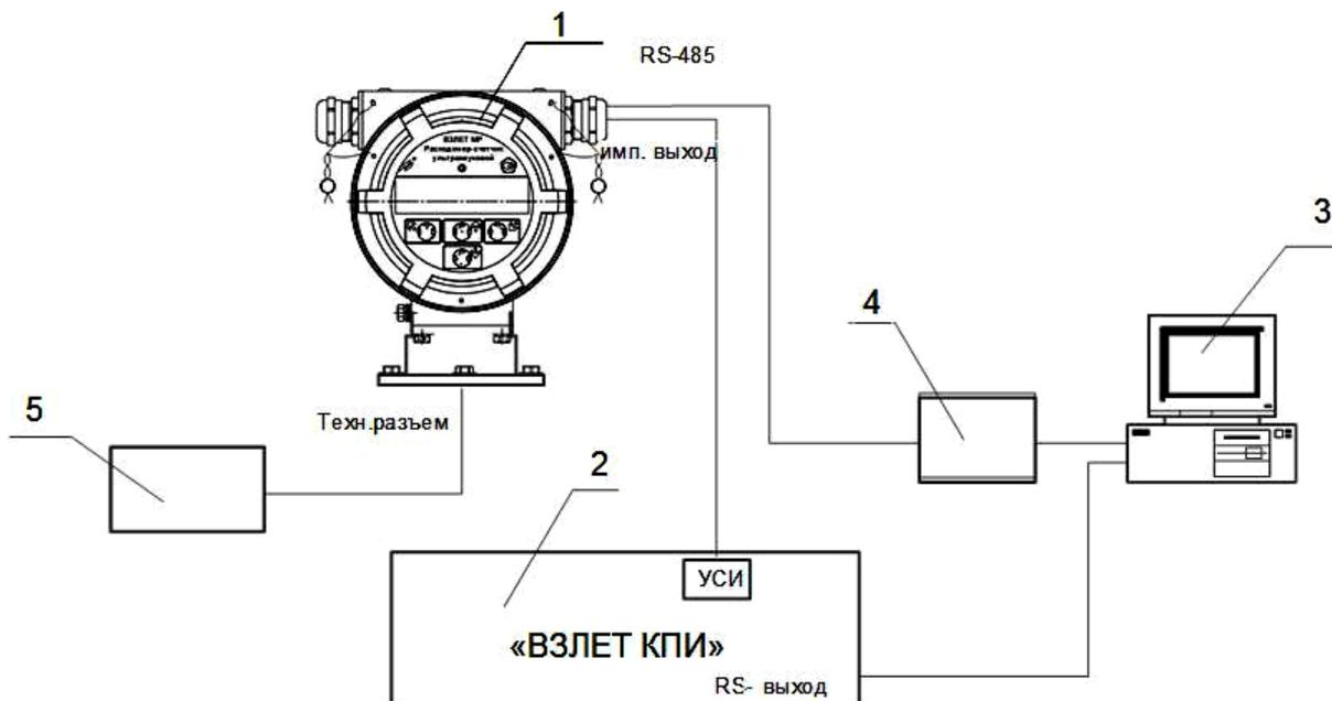
*1 – акустический стенд с установленными ПЭА; 2 – вторичный преобразователь поверяемого расходомера; 3 – персональный компьютер; 4 – конвертор интерфейса; 5 – комплекс поверочный «ВЗЛЕТ КПИ».*
