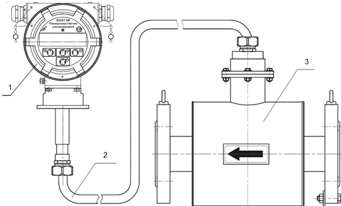
1 – вторичный преобразователь; 2 – кабель соединительный; 3 – измерительный участок.
