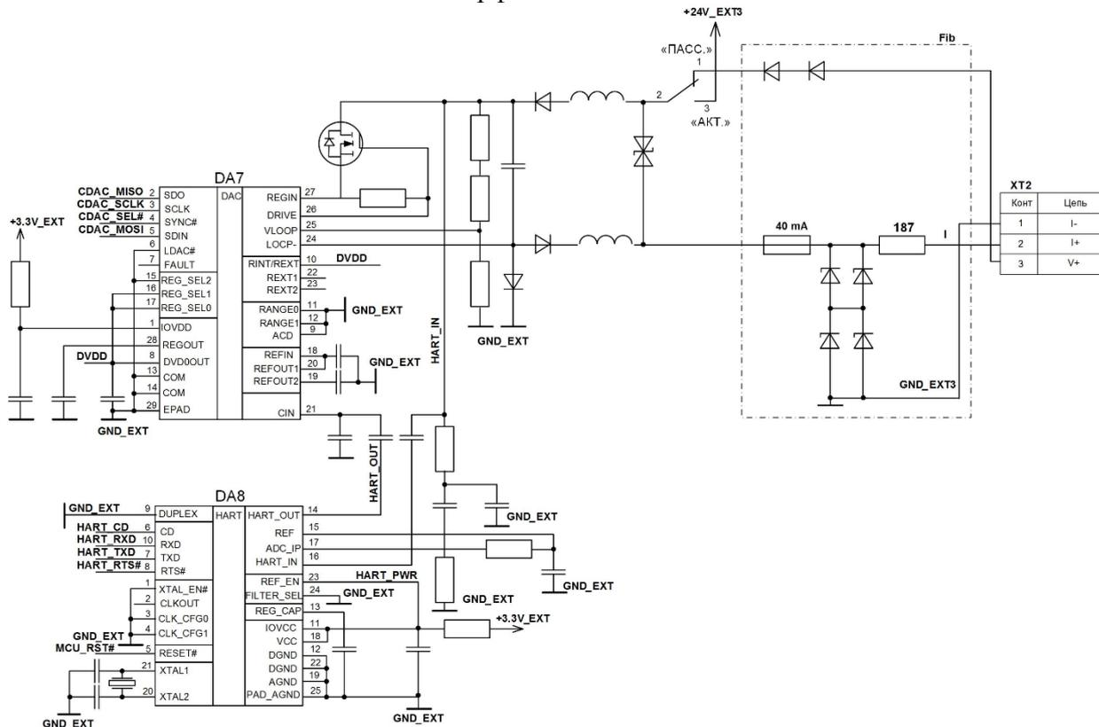
Рис.В.9 - Токовый выход с HART-интерфейсом
