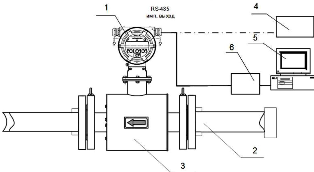
*1 – поверяемый расходомер; 2 – частотомер; 3 – персональный компьютер; 4 – конвертор интерфейса; 5 – трубопровод поверочной установки; 6 – измерительный участок.*
