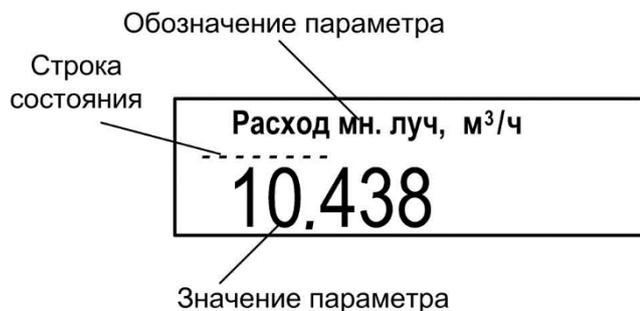
Рис.6 - Вид окна укрупненной индикации измеряемого параметра.
