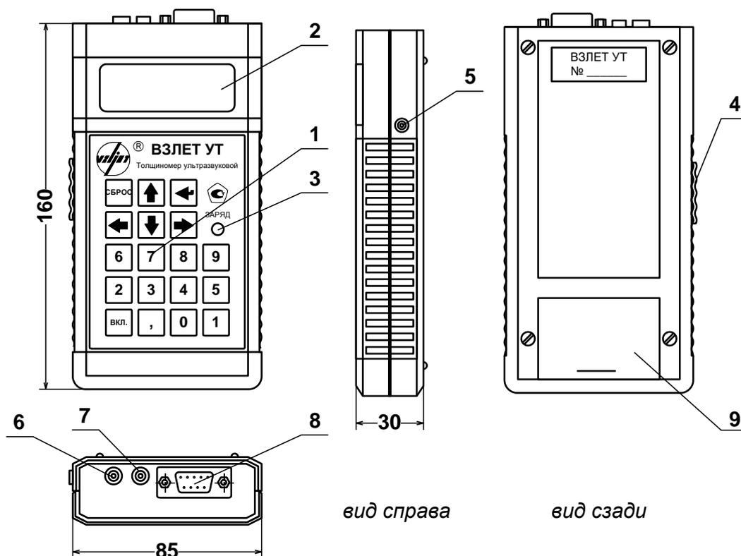
1 – клавиатура; 2 – жидкокристаллический индикатор; 3 – сигнализатор процесса заряда аккумулятора; 4 – выключатель подсветки индикатора; 5 – разъем подключения зарядного устройства; 6, 7 – разъемы приемника и передатчика соответственно (для подключения пьезоэлектрического преобразователя); 8 – разъем интерфейса RS-232; 9 – крышка отсека размещения батареи аккумуляторов.
