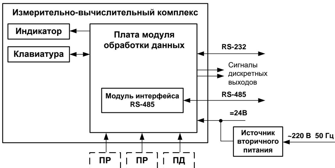
*ПР – преобразователь расхода; ПД – преобразователь давления.*
