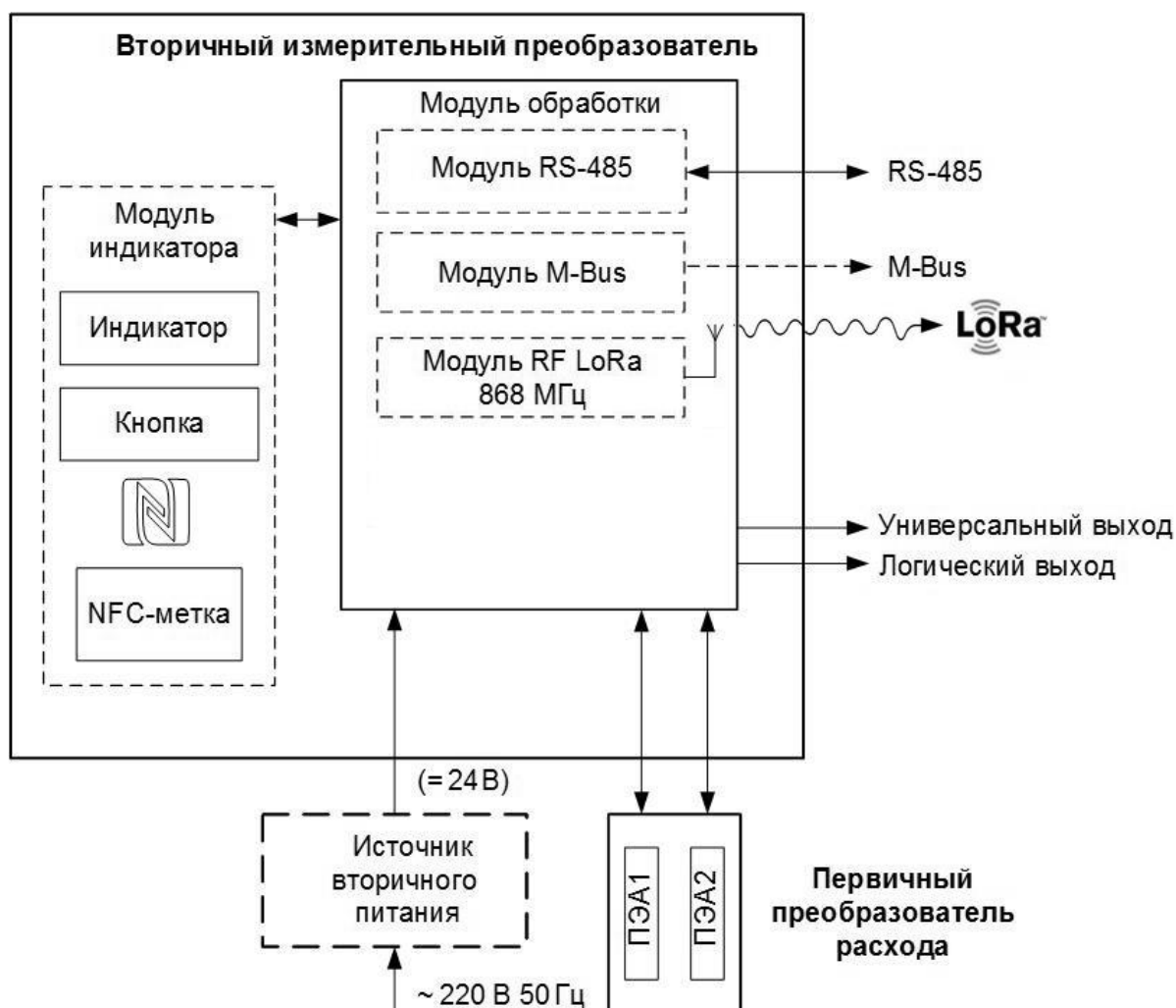
Рис.2. Структурная схема расходомера.
